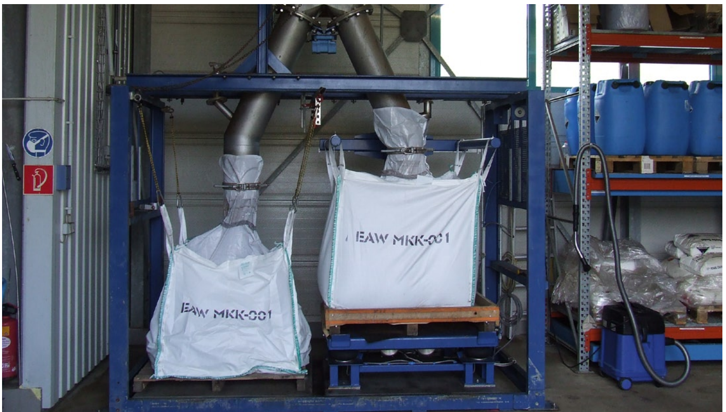
Abb. 2: Das schadstoffhaltige Salz wird nach der Trocknung in Säcke gefüllt, die in eine Untertagedeponie gefahren werden
