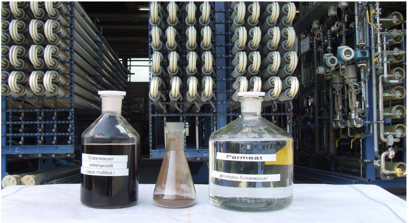
Abb. 1: Die Reinigungsleistung der Sickerwasserreinigungsanlage kann sich sehen lassen: Sickerwasser, abgetrenntes Salz-Granulat und gereinigtes Sickerwasser vor der Anlage in Gelnhausen-Hailer
