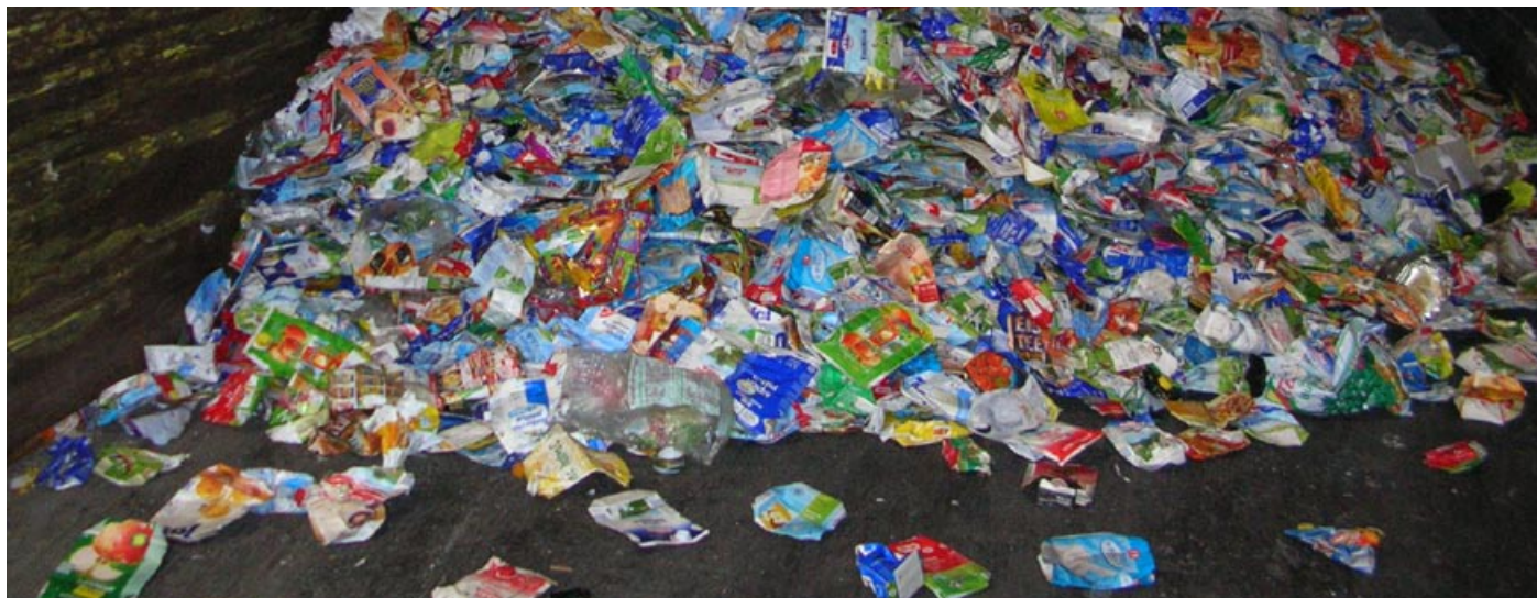
Abb. 2: Vollautomatisch aussortierte Getränkekartons vor dem Verpressen
