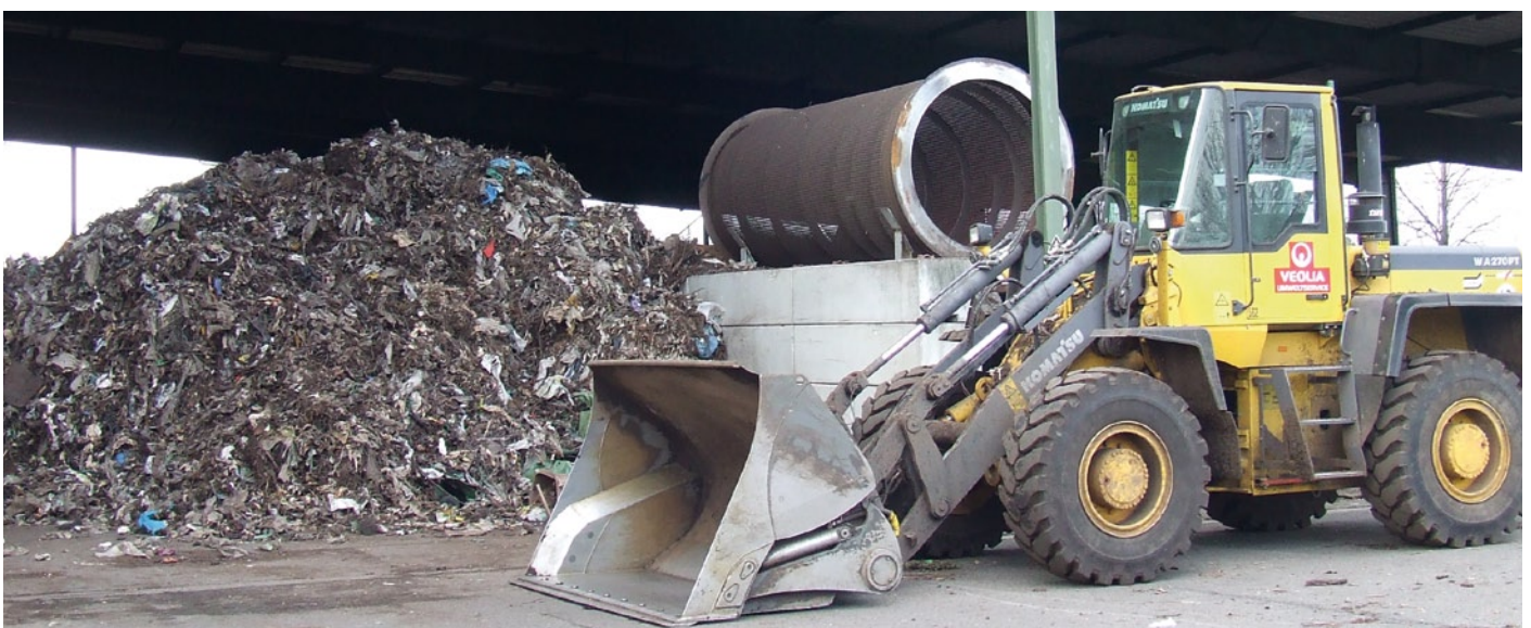
Abb. 3: Trommelsieb mit abgesiebten Störstoffen
