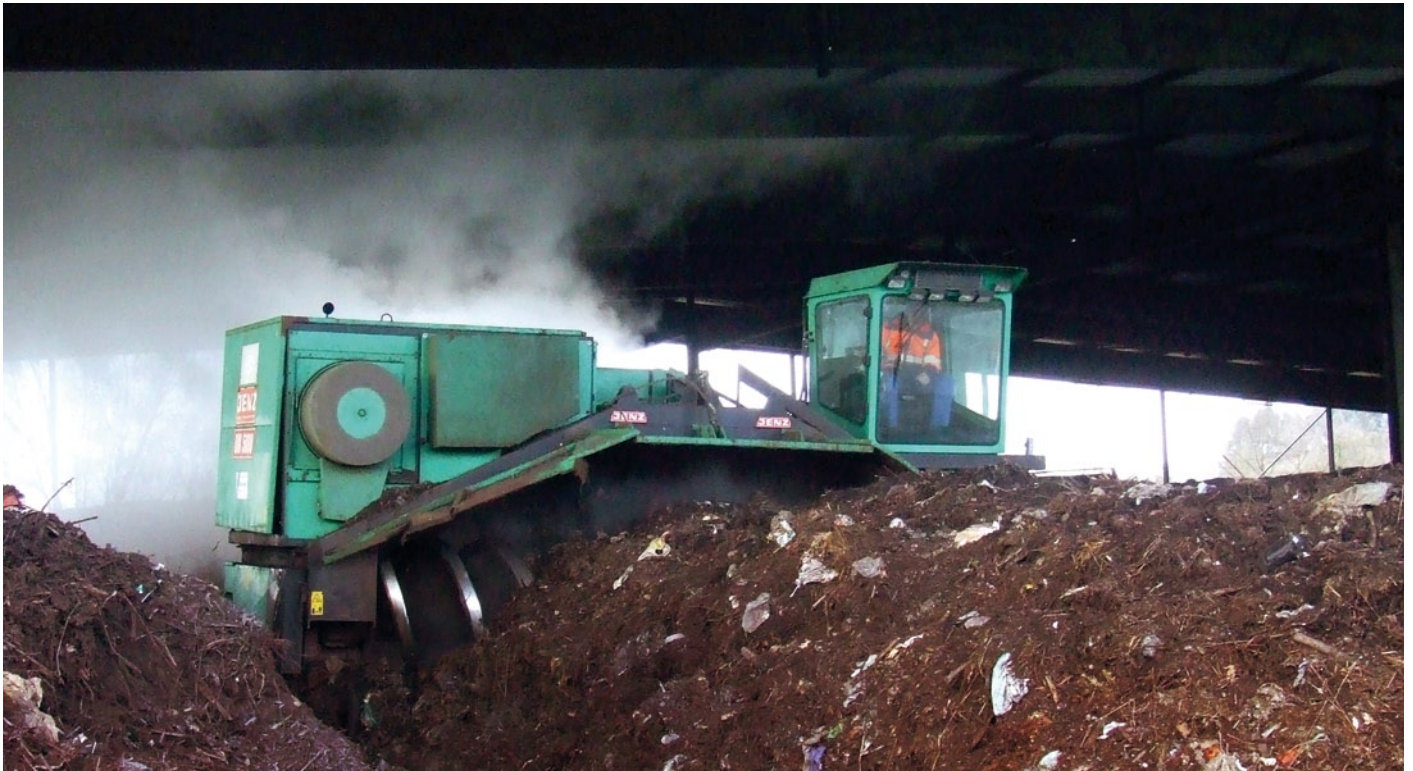
Abb. 1: Mit einem Spezialfahrzeug werden die Kompostmieten umgesetzt
